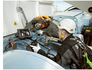
그림 1: 기어박스 살펴보기 터빈 검사자는 기어박스 손상을 빠르고 효율적으로 탐지하는 방법으로 비디오퓌코프를 사용합니다.
